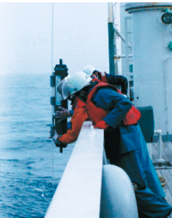
上：SEEDS2001における微量金属分析のためのクリーン採水。 左：SEEDS2001における鉄散布直後と散布後11日目のプランクトンネット試料の比較。 下：SEEDS2001の開洋丸船内に設置された簡易クリーンルームの中で濾過作業をする衣笠正敏さん（当時M2）。
