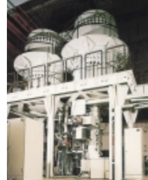
高さ約10m、総重量30トンの電子線分光型超高分解能電子顕微鏡(加速電圧1,000キロボルト)。平成元年設置。
