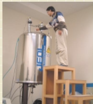
写真の垂直円筒部分は物質に強力な磁場を与える超伝導マグネット(ワイドボア型)で、高さ270cm、直径96cm。超伝導マグネットのほか分光器やコンピュータもある。ECA500-WB型。
