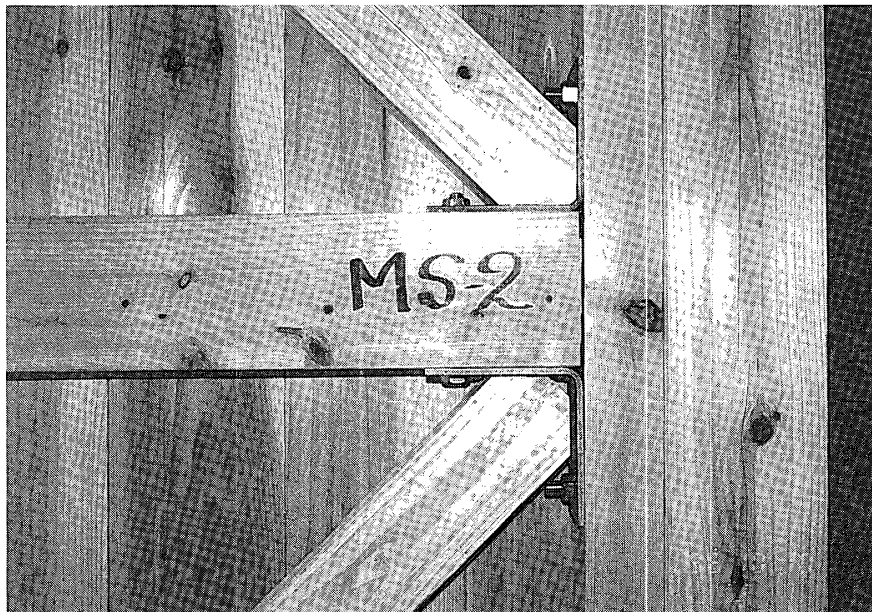
写真2 試験体 MS2 内枠固定用アングル部分詳細
