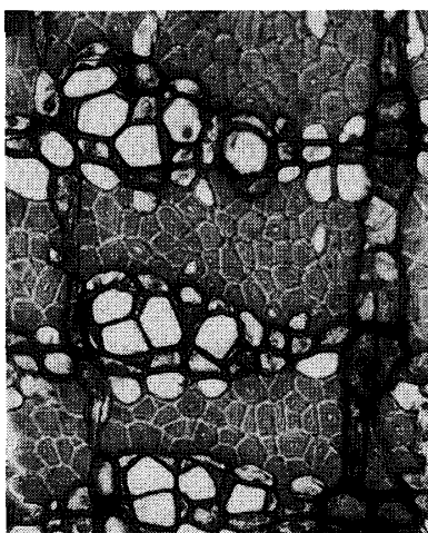
図6 シナノキの韌皮繊維群が層状に並ぶのがわかる。図の上方向が木の外周部にあたる。250倍。
