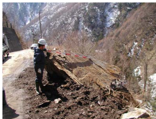
写真-2.1.8 落石と報告されることが多いが、発生源は不連続面に規制されており、明らかに岩盤崩壊。
