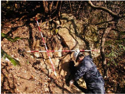
写真-2.1.10 花崗岩の露頭 不連続面は開口しているが変位はみられない。落下した岩塊形状から、下方が抜けてオーバーハングした岩塊が崩壊したものとみられる。
