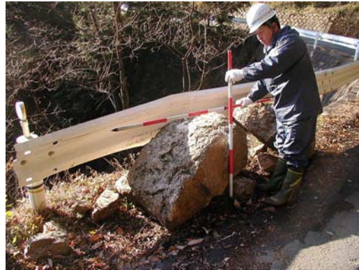
写真-2.1.10 花崗岩の露頭 不連続面は開口しているが変位はみられない。落下した岩塊形状から、下方が抜けてオーバーハングした岩塊が崩壊したものとみられる。
