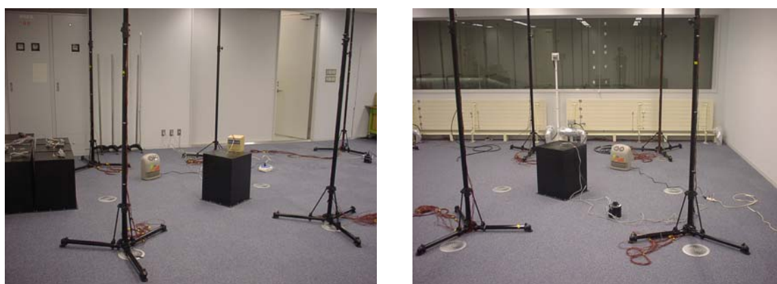
図 4.7 発熱体(黒い直方体)とファンヒータの配置の様子
