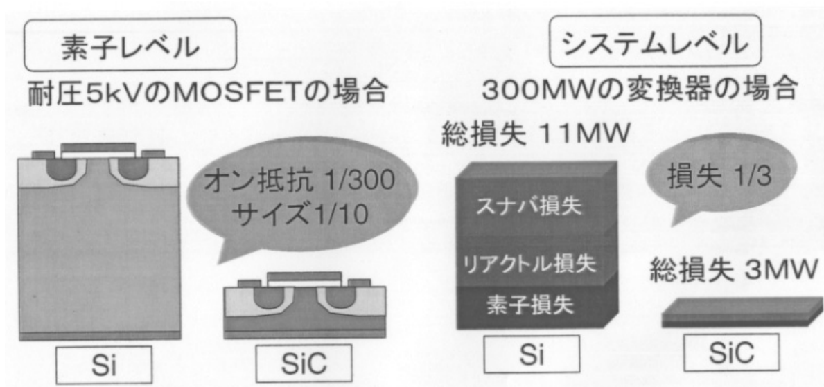
図4 SiおよびSiCパワーデバイスの比較
