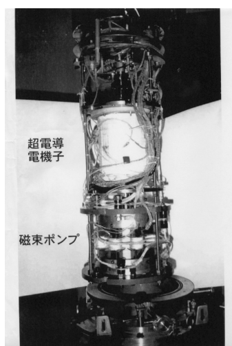
図1：20kVA級の全超伝導発電機の概観
