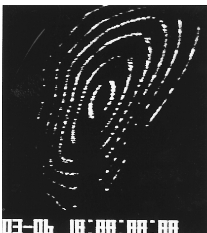
図1：ビーム蛍光法による磁気面計測の例 (ヘリオトロンJ装置)
