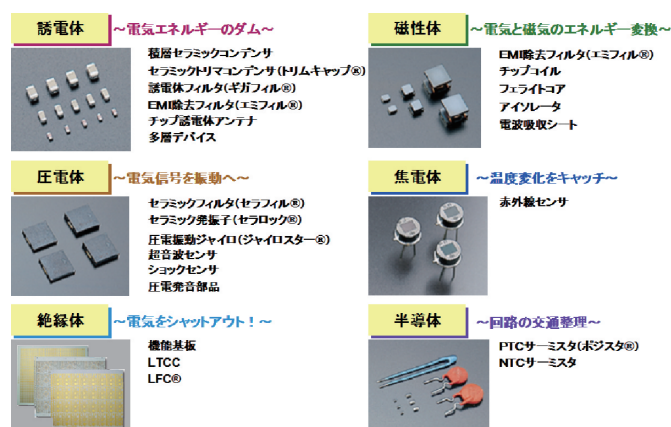
図1. セラミックスを使った電子部品
