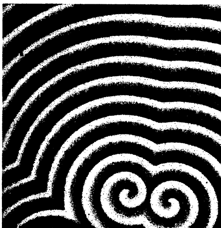
図 1 中心核に二つのラセン状の先端対を持つ化学反応波の伝播。反応波の波長は振動反応の周期により自己組織的に決定される。
