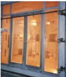
↑防火試験中の超耐熱結晶化ガラス「ファイアライト」
