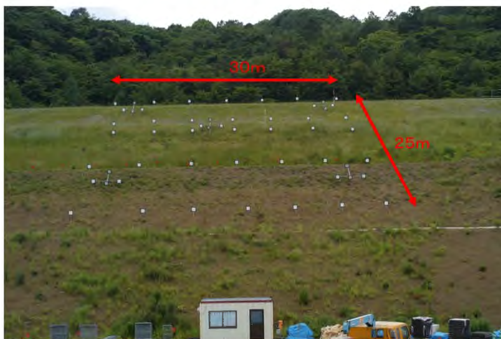
図 5.12 ターゲット設置状況
