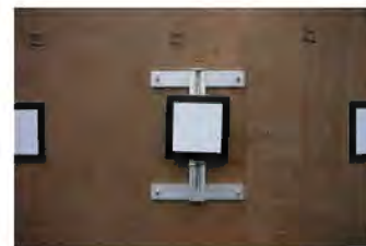
ターゲット移動装置をX,Y,Z方向に各3台ずつセットした。
