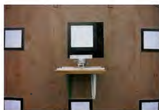
ターゲット移動装置をX,Y,Z方向に各3台ずつセットした。
