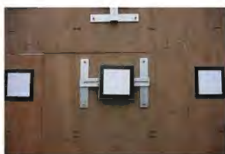
ターゲット移動装置をX,Y,Z方向に各3台ずつセットした。
