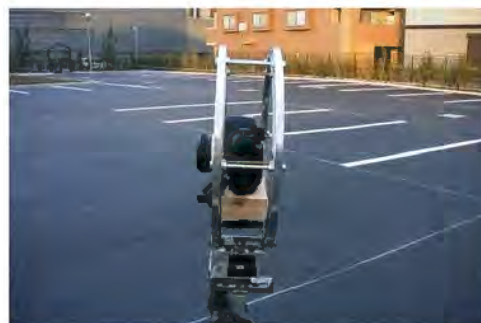
カメラ回転装置（側面）
