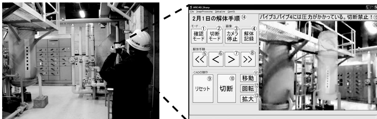
図1. 拡張現実感技術を用いた原子力発電プラント解体支援システム
