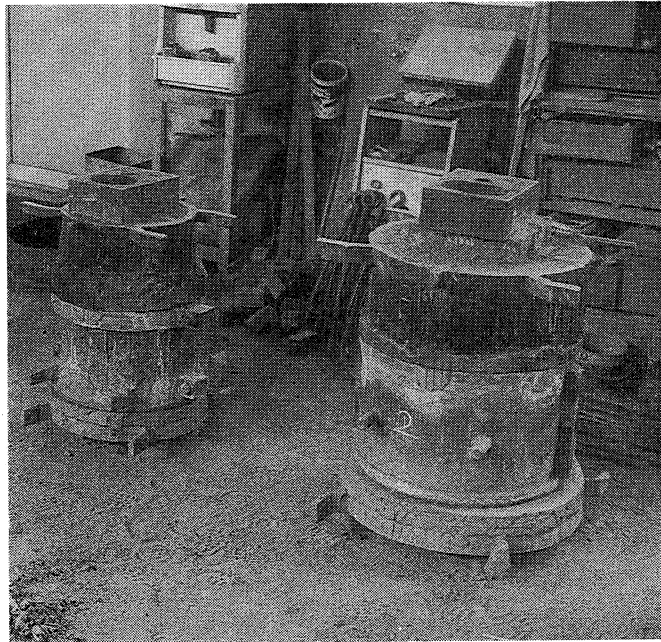
図25 半鐘の鋳造例 (昭和57年5月京都太秦 岩澤の梵鐘株式会社) 本例は湯入れをすませ た後で掛金(締金)をは ずしてある。
