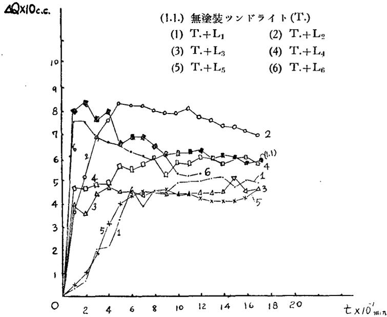
第六圖，第七圖，第八圖の實驗結果からして理論的考察の項に於て記述した様に，安定なる人造板の耐水塗膜層の吸水は Benetzung 並に Porenweit に關する二部分に區別して觀察し得られ，不安定な耐水塗膜層に於ては Poiseuilleschen Gesetz の成立なく，従つて上記二部分を區別して觀察すること不可能である．依つて人造板塗裝の耐水性は此等の曲線が描く徑路を觀察することによつて其の強弱並に安定度を知ることが出来る。
