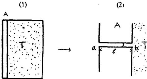
(第二圖の(2)) 空氣を排除しつゝ浸入し、b 點に到着す。扱此の際、毛細管が Benetzung し易い場合には、t 時間後 單位時間内に起る吸水量  $\Delta Q_A$  の極大値が吸水の最初に起り、後時間と共に漸次減少す。(第三圖の 1-曲線) 若し又毛細管が Benetzung
