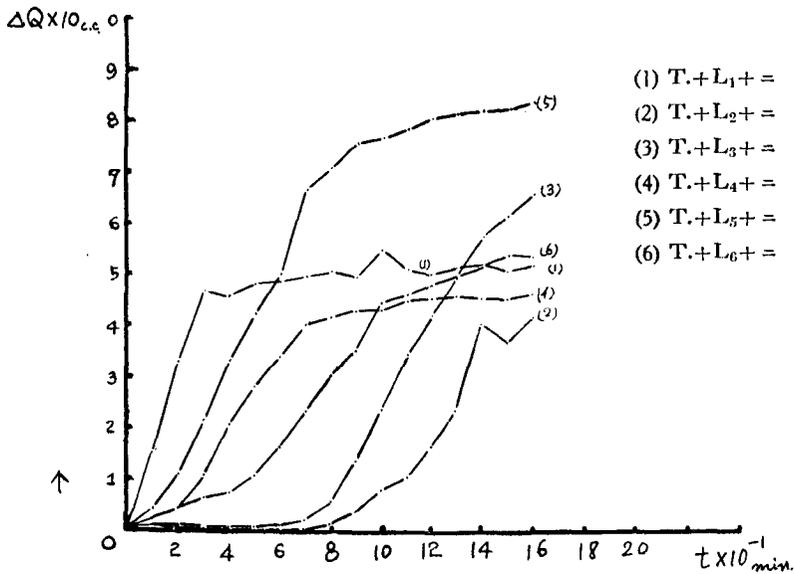
第七圖はツンドライトにラテックスゾルを下塗し、ニス塗料を上塗した場合である。實驗結果は第六圖と異なり、下塗回数に比例して耐水性を増加することなく全く順位不同である。且 Poiseuilleschen Gesetz に従はず。従つて此の場合の吸水を Benetzung 並に Porenweite による二因子に區別することが不可能である。即ち本塗装方法は第六圖の場合に比して耐水性弱く、實驗中塗膜層中に變化起ることを暗示す。
