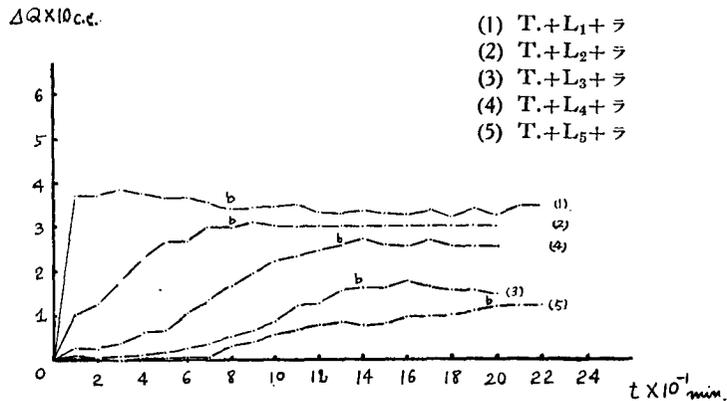
第六圖は縦軸に t 時間後、一定時間(10 分間)内に起つた吸水量、 $\Delta Q$  を取り、横軸に時間、t (單位 10 分)を取つて圖示した曲線であつて、(以下同様)ツンドライトにラテックスズルを下塗し、シケラックを上塗した混用塗裝の耐水試験である。大略下塗回数に比例して耐水性を増加す。曲線(1)は比較的 Benetzung し易き爲め、吸水量
