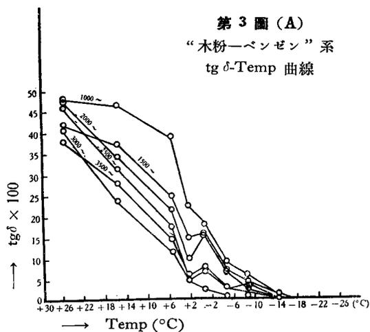
+ 2.5°C との間に於て誘電體損の不連続的急降下を來し、異狀吸收を表はし、其より温度降下に伴ふ誘電體損降下は、徐々にして -14°C より -16°C の間に於て高周波の方より測定不能に陥る。
