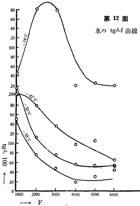
本圖に於ては縦軸に  $tg\delta \times 100$  を表はし、横軸に周波数を示す。此の場合に於て  $tg\delta$  の極大點は高温になる程高周波の方に移るものにして例へば  $-34^\circ\text{C}$  に於ては 2,500 位に其の極大點を見るも、 $-42^\circ\text{C}$  にては 1,300 邊にして、尙降つて  $-58^\circ\text{C}$  に至つては我々の測定周波數に於ては  $tg\delta$  の極大點を表はさず、もつと低周波側多分 250 邊にあるものと思はる。
