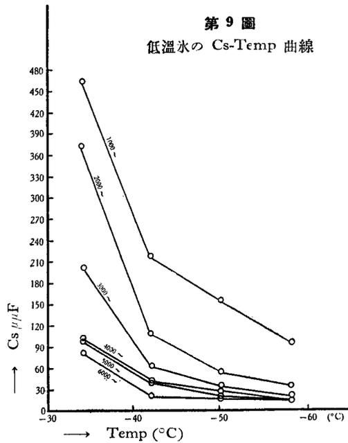
本圖に於ては縦軸に Cs を  $\mu\text{F}$  で表はし、横軸には温度を示す。圖より明かな様に温度降下と共に Cs の連続的降下を來す。
