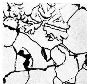
第12圖 焼戻 試料 C 2 500°C×550
