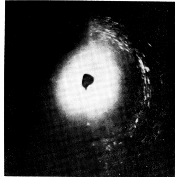
第十一圖 固溶體 Al+Cu を 150°C にて數時間焼鈍せしもの (Cu K \alpha )
