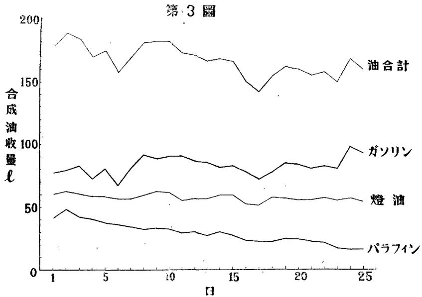
爐中の冷却管の熔接箇所故障を生じ、冷却用熱水が合成爐内に漏洩して来たので直ちに運轉を中止し修理した。10月27日午前中に於て修理完了し、直ちに運轉を開始し、10月28日午後1時より正常の状態となり、再び順調な運轉を續けた。かくて11月3日まで熱水温度を 235°C に保持したが、觸媒の活性には些したる減退も認められず、反應温度を上昇せしめる必要は無かつたが、特に温度上昇の影響を見る爲に11月3日に熱水温度を 3°C 上昇せしめ、試験を續け、11月6日午前10時を以て試験を終了した。この合成試験の成績を第4表、第2圖及び第3圖に示し、合成試験中に於ける觸媒の加熱状況を第5表に又合成反應によるガス組成の變化を第6表に、尙この場合同一合成ガスを用ひて行つた小規模合成試験(4l/hr.)の結果をも参考の爲第7表に示した。此等の表及び圖の日數は10月9日より起算し、10月25, 26, 27日、即ち還元及び故障中を除いて計算したものである。
