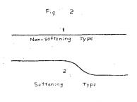
軟化膨脹曲 康を大略分類すれば第2圖に示す様に非 軟化型,軟化型,軟化膨脹型の三種に分類される.
