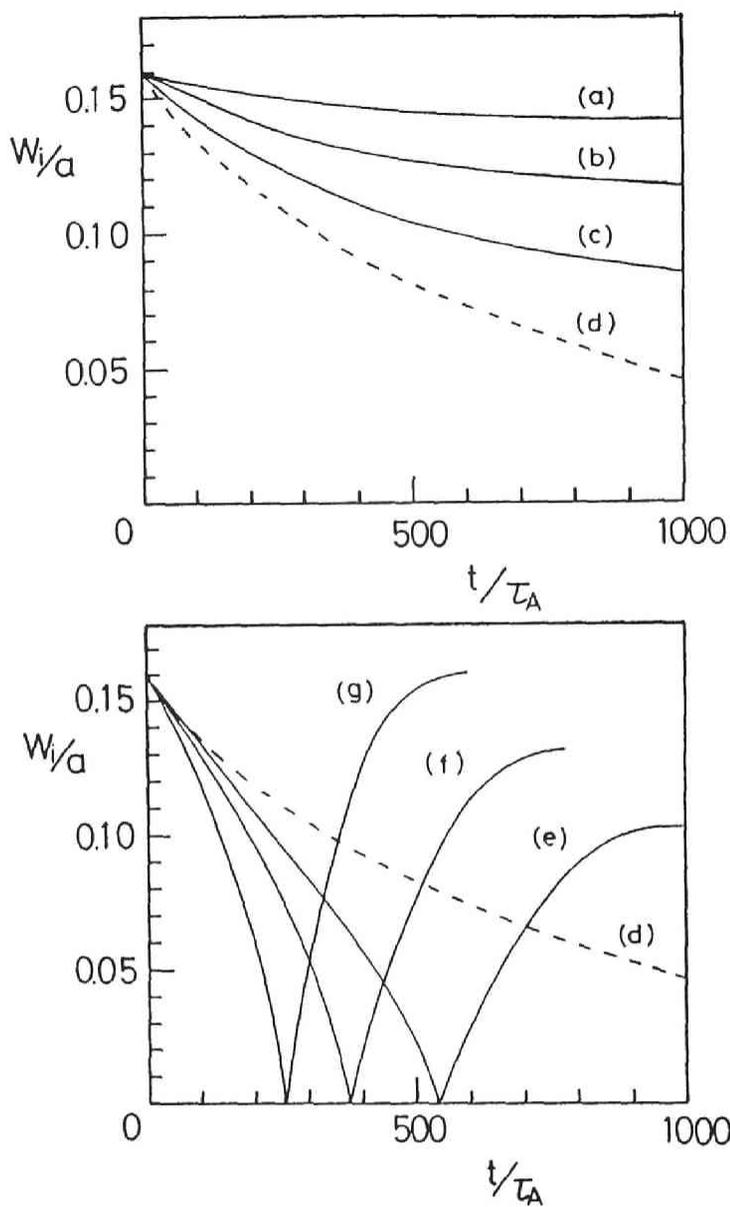
図 4.9 磁気島の時間発展。パラメータは (a)  $\gamma = 0.25$ , (b)  $\gamma = 0.5$ , (c)  $\gamma = 0.75$ , (d)  $\gamma = 1.0$ , (e)  $\gamma = 1.25$ , (f)  $\gamma = 1.5$ , (g)  $\gamma = 2.0$  である。磁気レイノルズ数は  $S = 10^4$  をとっている。
