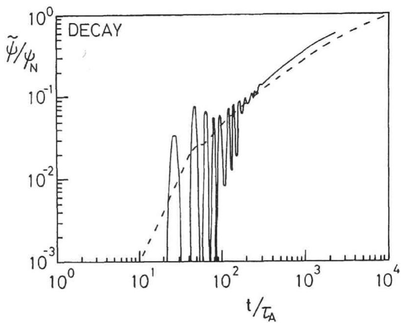
図 5.8 セパラトリクス X 点での磁束関数  $\tilde{\psi}$  の成長。
