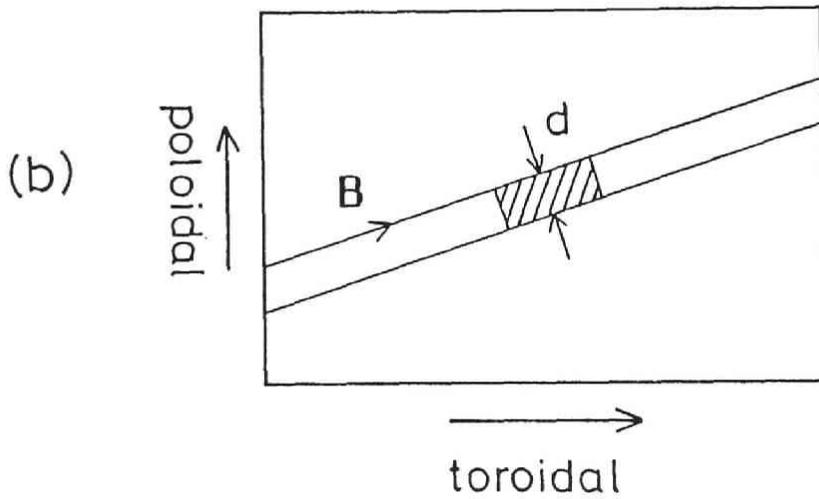
図 3.16 モデルの形状。(a) ポロイダル断面と (b) リミターヘッドでの磁気面の展開図。(b) の斜線部分はリミターヘッドが当たっている箇所を示す。
