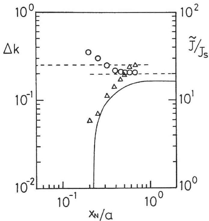
図 5.9 セパトリクス  $X$  点の電流値  $\tilde{J}$ 、電流層の巾  $\Delta$  とテスト磁気島の実効的な巾  $W_s$  の  $x_N$  依存性。 $o$ ,  $\Delta$  はそれぞれ  $\tilde{J}$ ,  $\Delta$  に対応する。実線は  $W_s$ 、点線は単一磁気島での  $\tilde{J}$ ,  $\Delta$  の値を示す。パラメータは図 5.2 と同じである。
