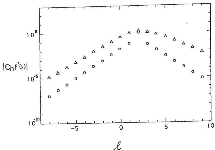
図 2.18 境界外部のポテンシャル係数。o 印が図 2.17(a)、 $\Delta$  印が図 2.17(b) の場合である。 $l=2$  から離れるにつれてポテンシャル係数が指数関数的に減少してゆくことが分かる。
