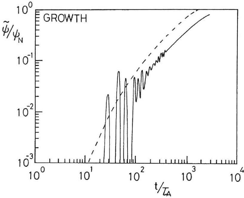
図 5.4 セパトトリクス  $X$  点での磁束関数  $\tilde{\psi}$  の成長。パラメータは  $\delta/a = 10^{-2}$ ,  $ak = 1$ ,  $S = 10^5$  であり、隣接磁気島の位置及び巾は図 5.1 と同じである。
