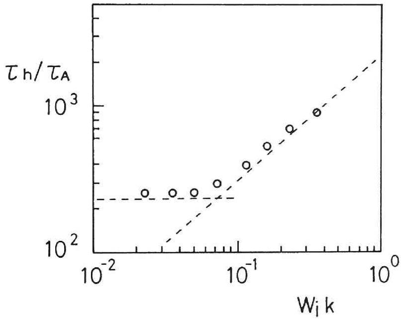
図 4.8  $\tau_h$  と磁気島巾  $W_i$  の関係。パラメータは  $S = 10^5$  である。 $W_i$  が大きくなると、 $\tau_h$  は  $W_i$  に依存する様になり、 $S$  に比例する。
