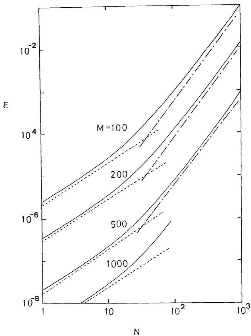
図 2.A.1 磁力線追跡の際に生じる数値誤差。点線と一点鎖線はそれぞれ  $N, N^2$  に比例する直線を表す。
