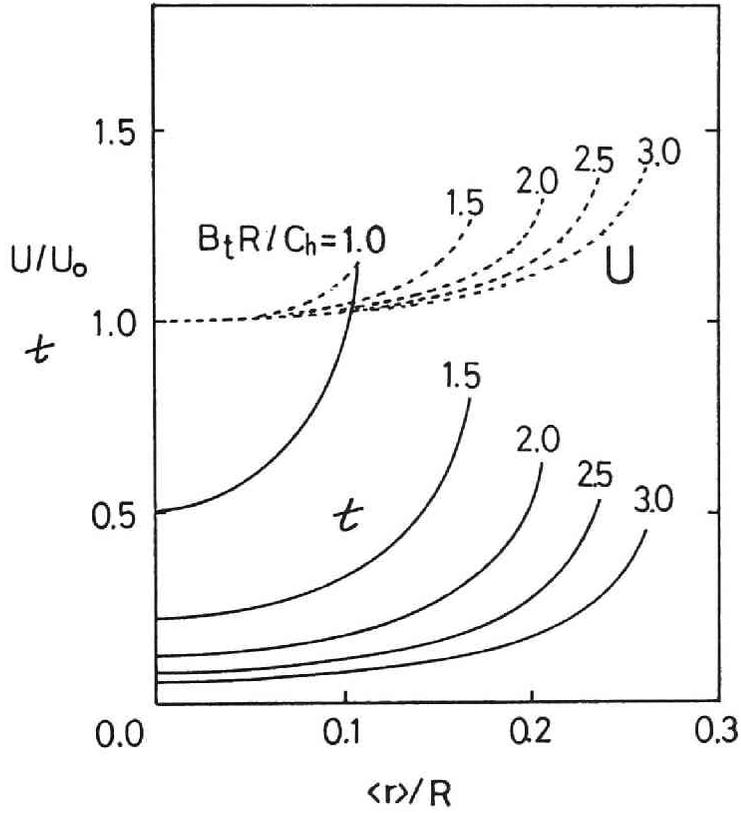
図 2.5 トロイダル磁場  $B_t$  を変化させたときの  $\dot{\gamma}, U$  の径方向分布。 $B_t$  が大きくなるほど、全体の  $\dot{\gamma}$  とシアーが小さくなる。
