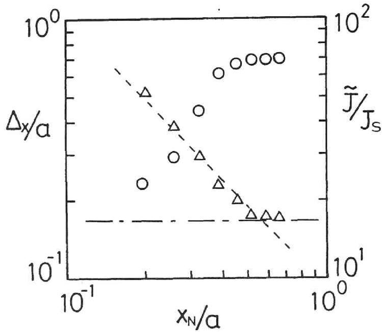
図 5.6 セパトリティクス  $X$  点での電流値及び電流層の巾  $\Delta_x$  の  $x_N$  依存性。
