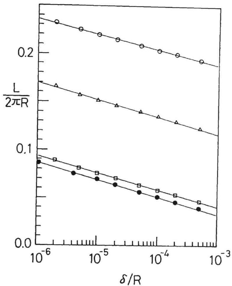
図 3.3 接続長の漸近的振る舞い。 $\delta$  は表面からの距離である。●, □, △, ○印はそれぞれトーラス内側の OMS、トーラス内側の  $\epsilon = 19/3, 19/5, 19/7$  の場合である。
