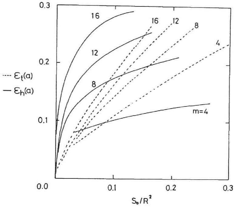
図 2.15 リップル率の  $S_0$  依存性。  $B_v = 0.0$  としている。実線が  $\epsilon_h(a)$ 、点線が  $\epsilon_t(a)$  を示す。
