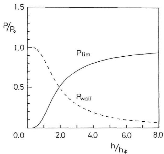
図 3.17  $\alpha = 0$  の場合の (a) リミター挿入長とリミターヘッドでの磁気面の温度の関係と、(b) リミター挿入長と  $P_{lim}, P_{wall}$  の関係。
