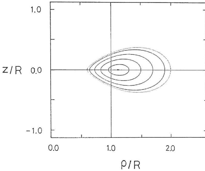
図 2.B.1  $\ell = 2, m = 2$  の真空磁気面。パラメータは  $B_t R / C_h = 4.0, B_v R / C_h = 0.036$  で、評価量は  $\epsilon(0) = 0.11, \epsilon(a) = 0.14, R/a = 1.97$  である。
