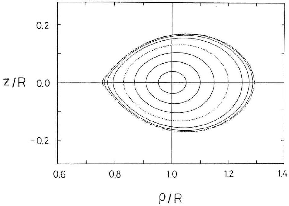
図 2.3  $l = 2, m = 8$  の真空磁気面のポロイダル断面。パラメータは  $B_t R / C_h = 2.0, B_v R / C_h = 0.0$  である。
