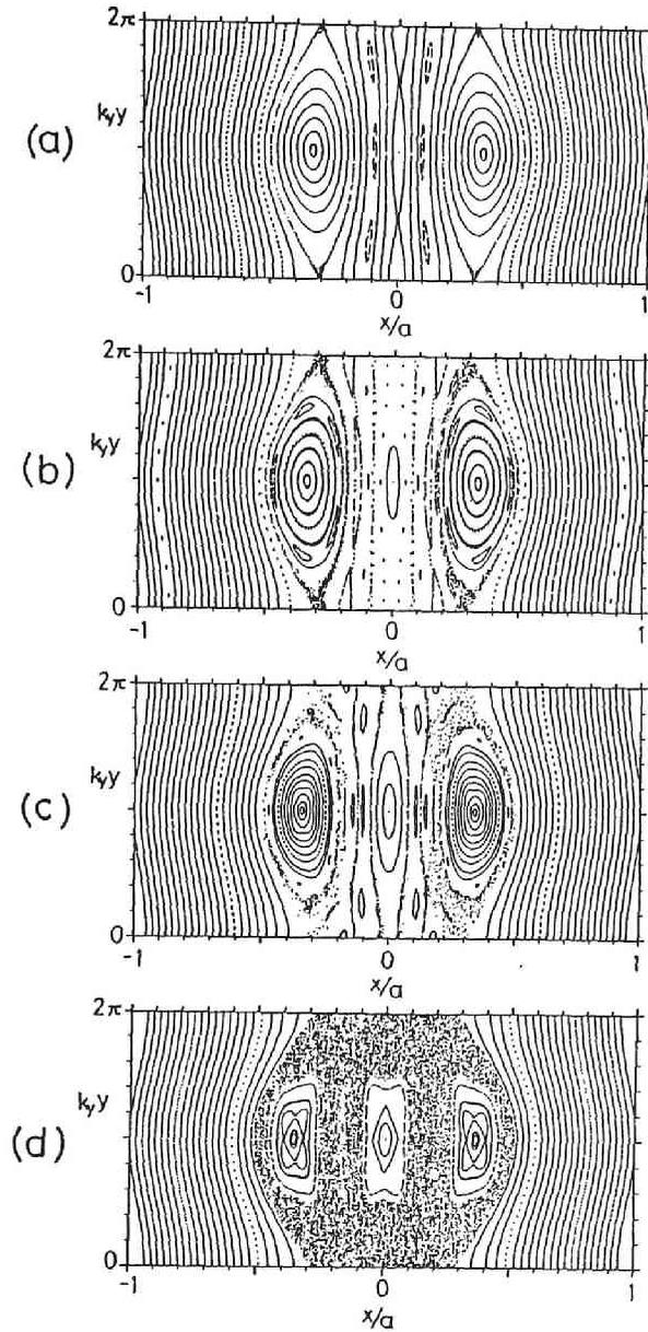
図 5.1 モデルの形状。隣接磁気島の巾  $W_N$  及び隣接距離は  $W_N/a = 0.322$ ,  $x_N/a = 0.324$  である。テスト磁気島の巾  $W_T/a$  は (a) 0, (b) 0.03, (c) 0.25, (d) 1.0 であるテスト磁気島が成長する程、ストカスティックな領域が広がってくるのがわかる。
