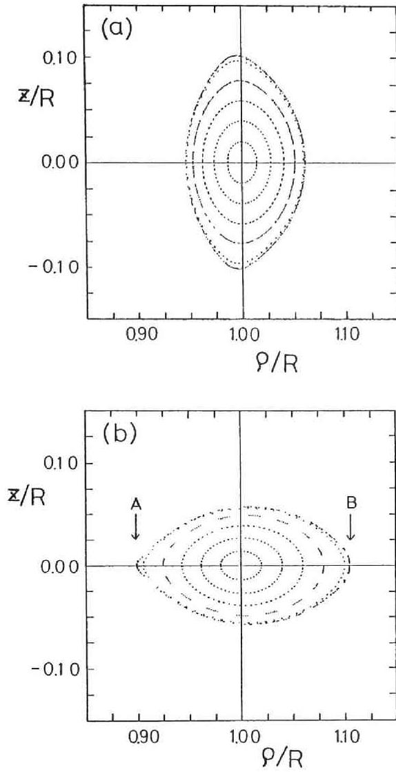
図 3.1 真空磁気面の例。Heliotron-E ( $\ell = 2, m = 19$ ) を模擬している ( $B_t R / C_h = 0.65, B_v = 0$ )。(a) が  $\phi = 0$ 、(b) が  $\phi = \pi/2m$  のポロイダル断面図である。
