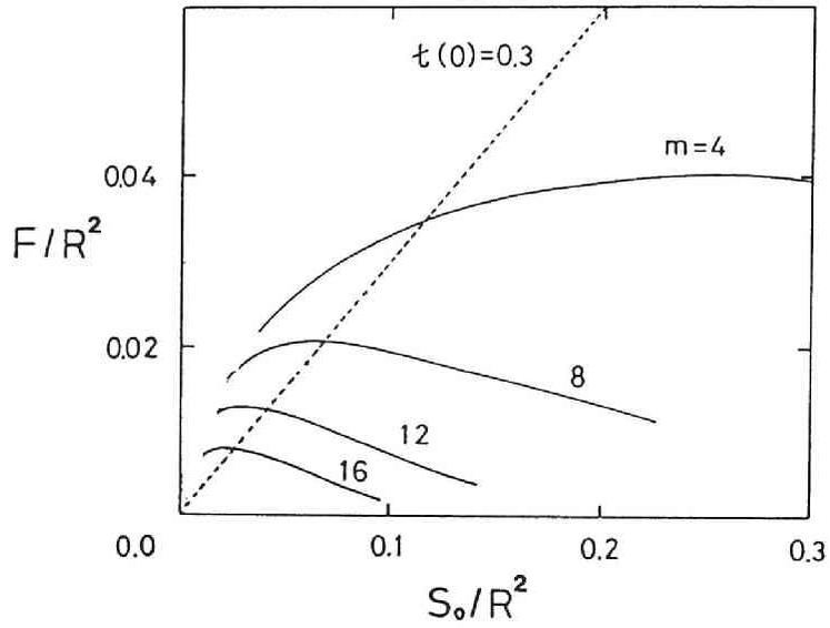
図 2.14 評価関数  $F$  の  $S_0$  依存性。 $B_v = 0.0$  としている。点線は  $t(0) = 0.3$  の直線である。
