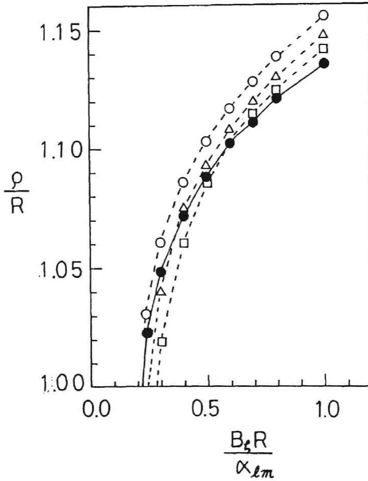
図 3.6 OMS と磁気島 O 点の位置。○, △, □, ● 印はそれぞれ  $l = 19/3, 19/5, 19/7$  の O 点、そして OMS に対応する。トロイダル磁場増大と共に径の外方向へ動く。
