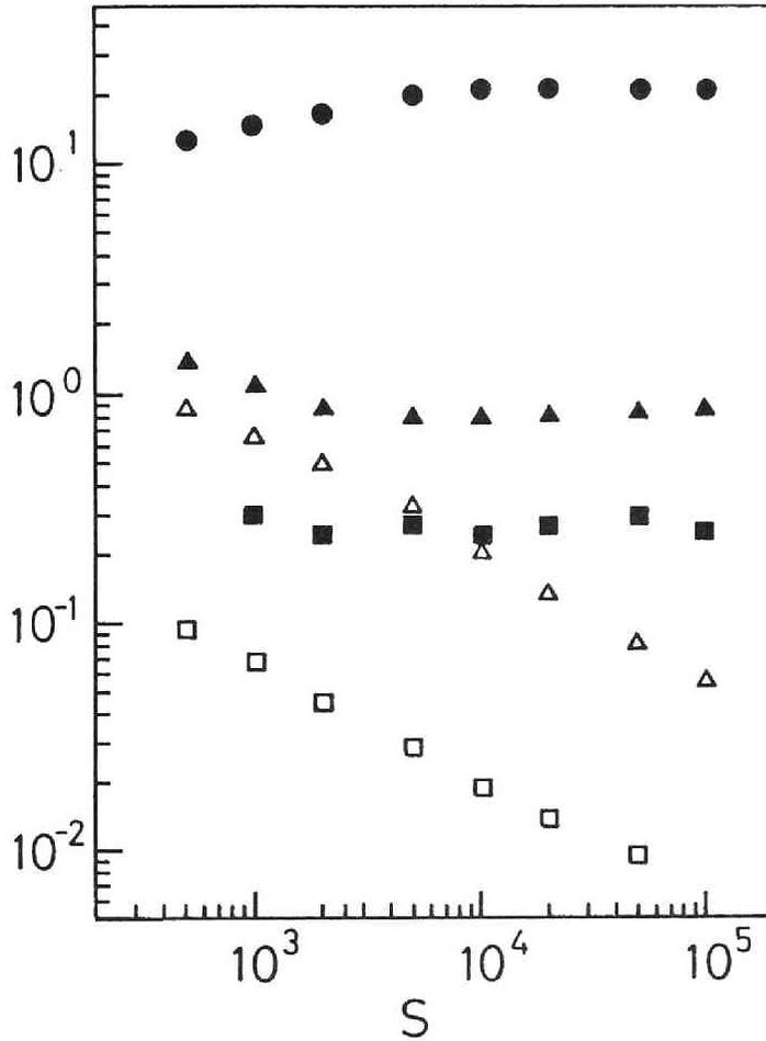
図 4.6 電流層の中  $\Delta$  とセパトリクス  $X$  点における電流密度  $\tilde{J}$  の  $S$  依存性。 $\Delta$  の添え字  $x, y$  は  $x$  方向、 $y$  方向の中を意味し、 $h, 0$  はそれぞれ電流値が  $\tilde{J}(0)/2, 0$  になる位置を表す。印  $\bullet, \blacksquare, \blacktriangle, \square, \triangle$  はそれぞれ  $\tilde{J}/J_s, \Delta_{x0}k, \Delta_{y0}k, \Delta_{xh}k, \Delta_{yh}k$  に対応する。これらは  $\tilde{\psi}/\psi_s = 0.25$  での値である。
