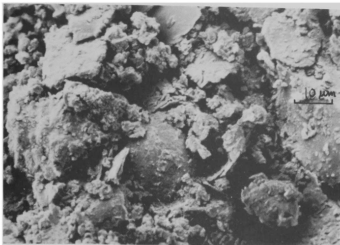
写真 5.9 I - 6 試料の 1 軸圧縮 すべり面 ×1000
