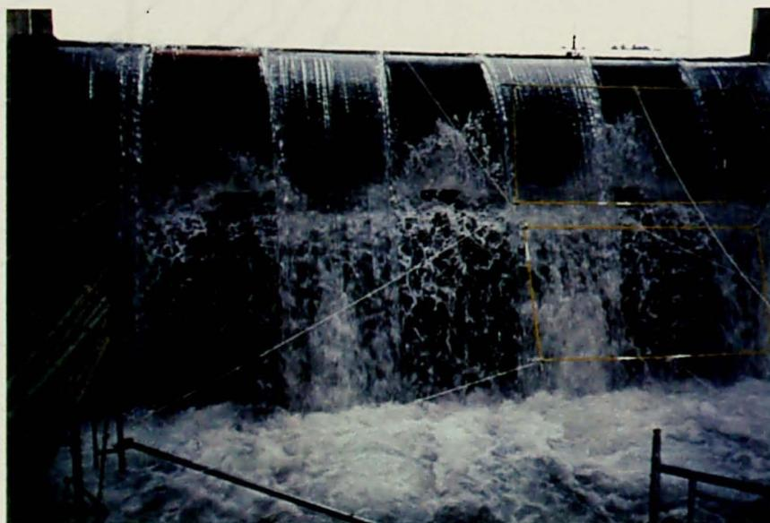
写真-5.2 A型スポイラ流況(ケース5, 越流水深15cm)
