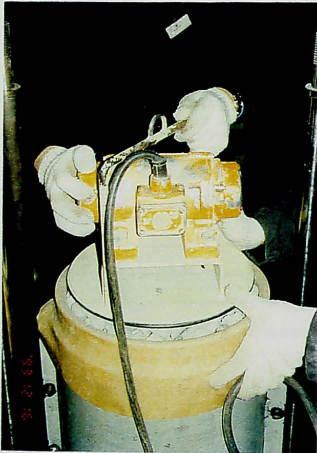
図5-1-2 小型バイブレータによる締固め
