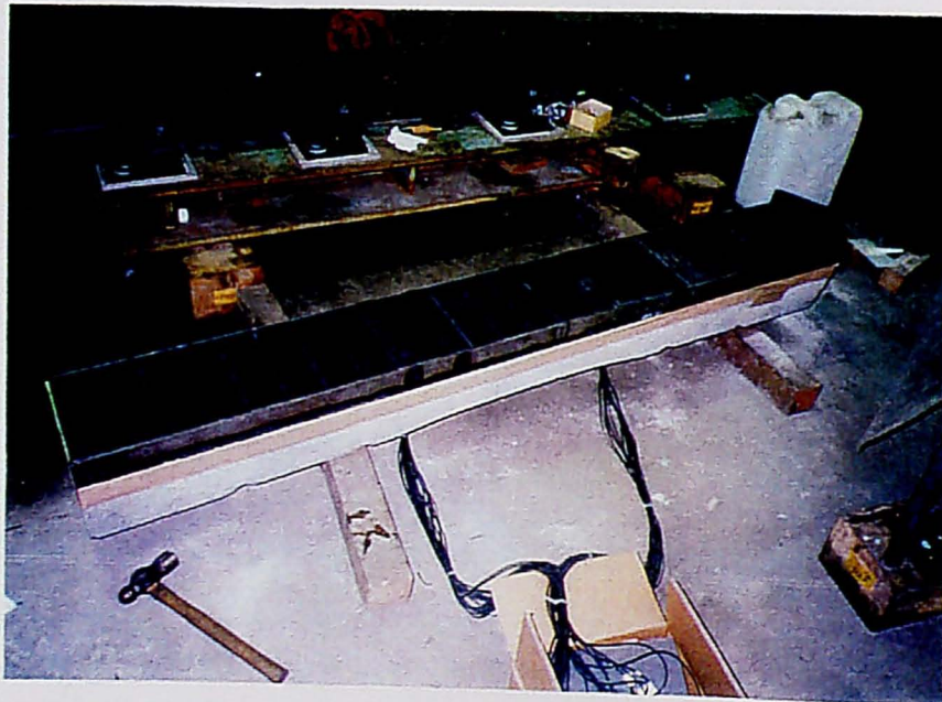
図4-1-13 まくらぎ下面圧力測定用PCまくらぎ
