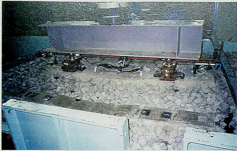
圖4-1-2 上下方向載荷試驗裝置
