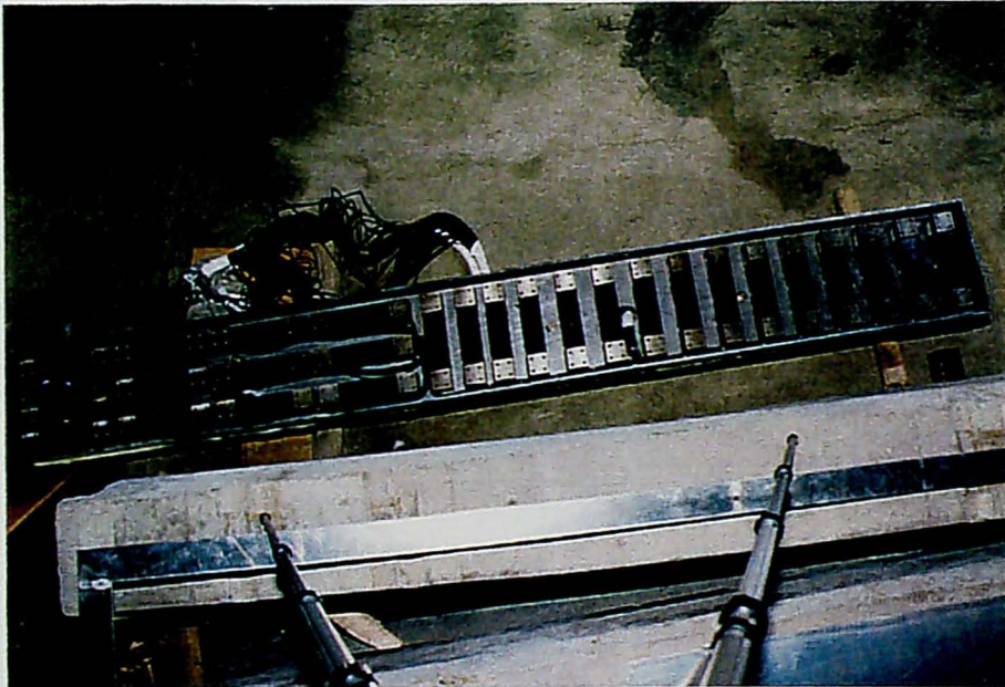
(b) 2方向ロードセル設置状況
