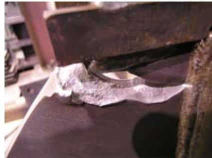
写真 7.6 外ダイアフラム-梁フランジ溶接部の破断 (A-2)
