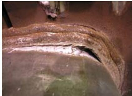
(a) 偏心側の溶接部の亀裂,
