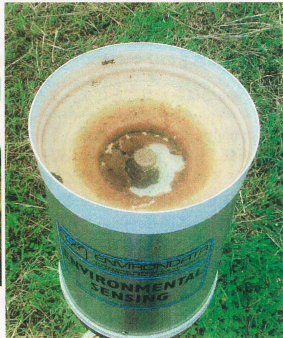
図 4: Khumartar 観測所の AWS の雨量計。雨水がたまり、水苔が繁茂している
