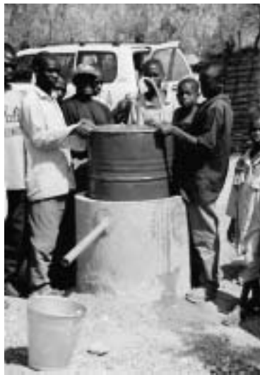
写真 3 セメント管とドラム缶で作製したバイオガス発生装置
