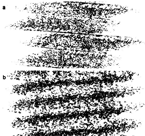
図 3: 2 次元の数値実験で再現された水平貫入。可視化は、数値的に構成したシャドウグラフ法による。a) 前線面をはさんでの溶質の差が小さい場合 ( \Delta = 150 )、b) 大きい場合 ( \Delta = 400 )。
