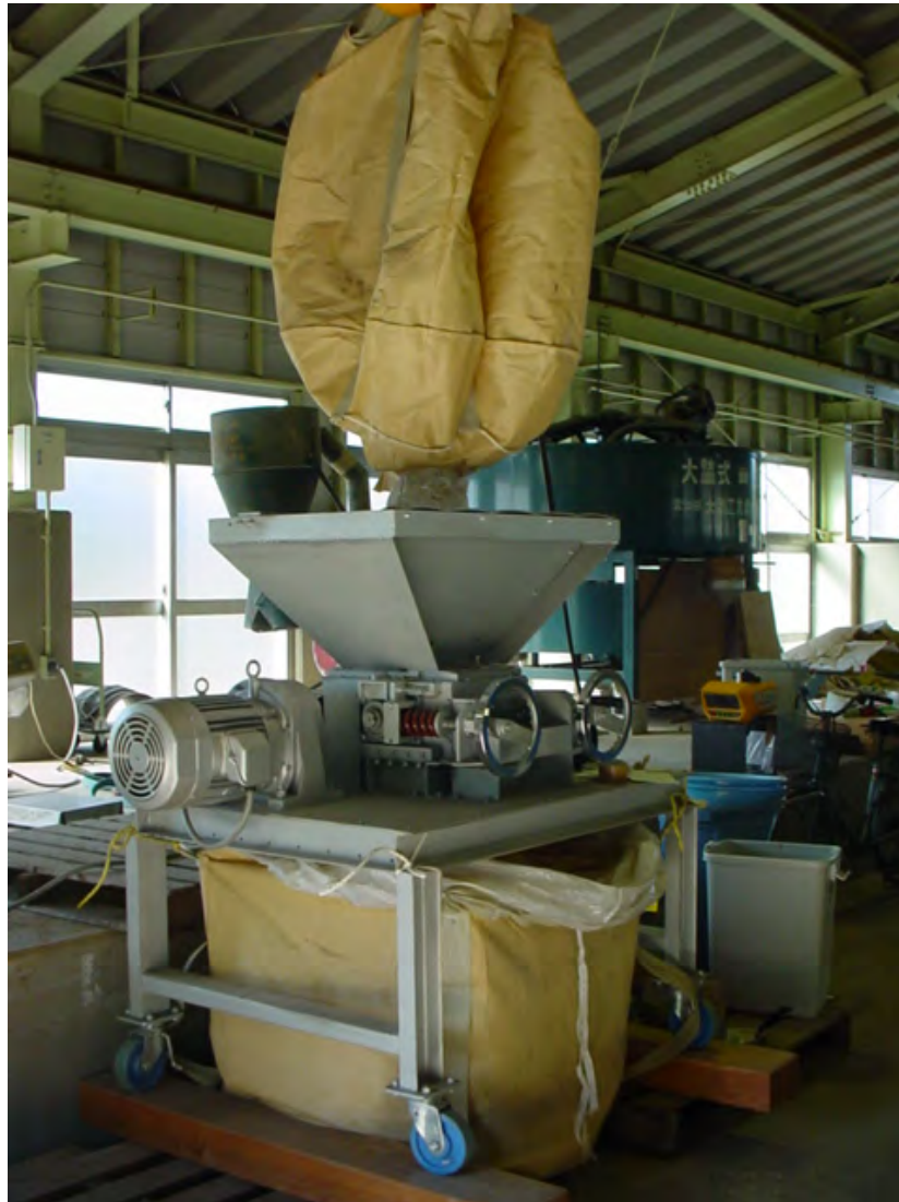
図 5.1 粳破碎装置による飼料米破碎作業
