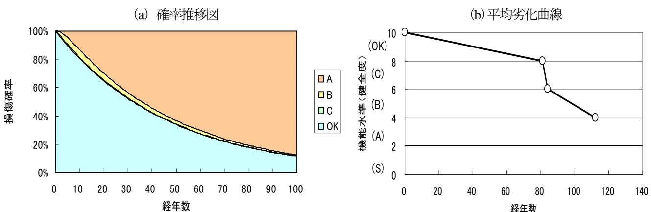
図4-16 確率推移図と平均劣化曲線（坂井(2008)<sup>25)</sup>
