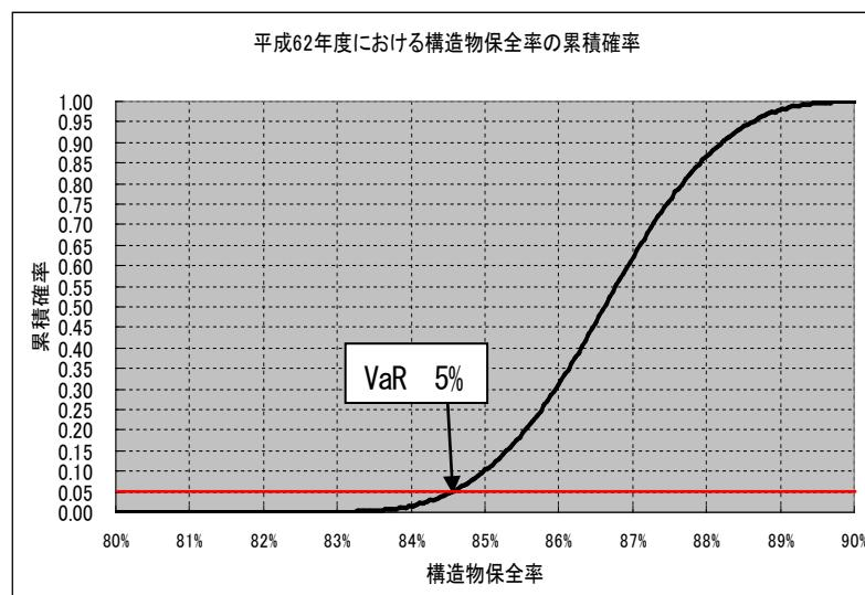
図5-4 構造物保全率分布の確率分布イメージ
