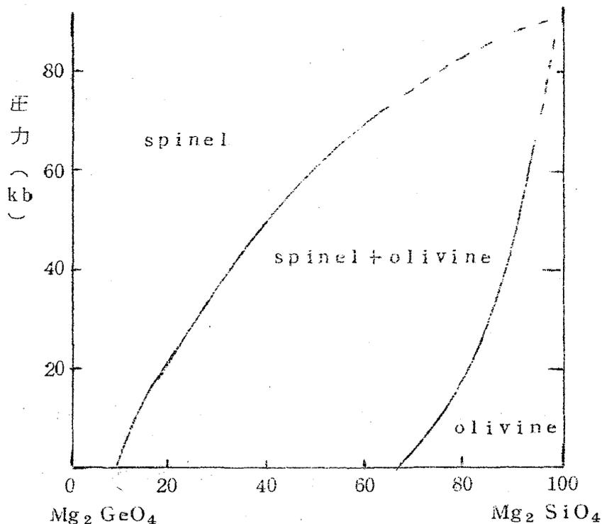
図3-2.  $Mg_2GeO_4 - Mg_2SiO_4$  系の相図 (542℃)
