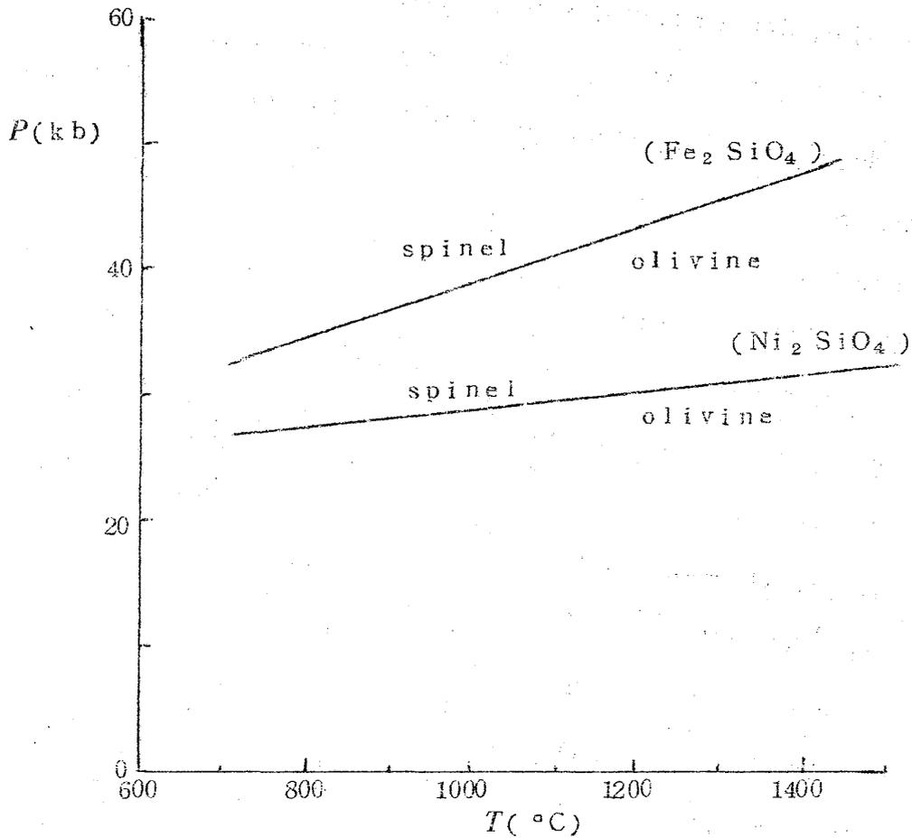
図 3-3.  $\text{Ni}_2\text{SiO}_4$ ,  $\text{Fe}_2\text{SiO}_4$  の olivine-spinel 転移に対する相図
