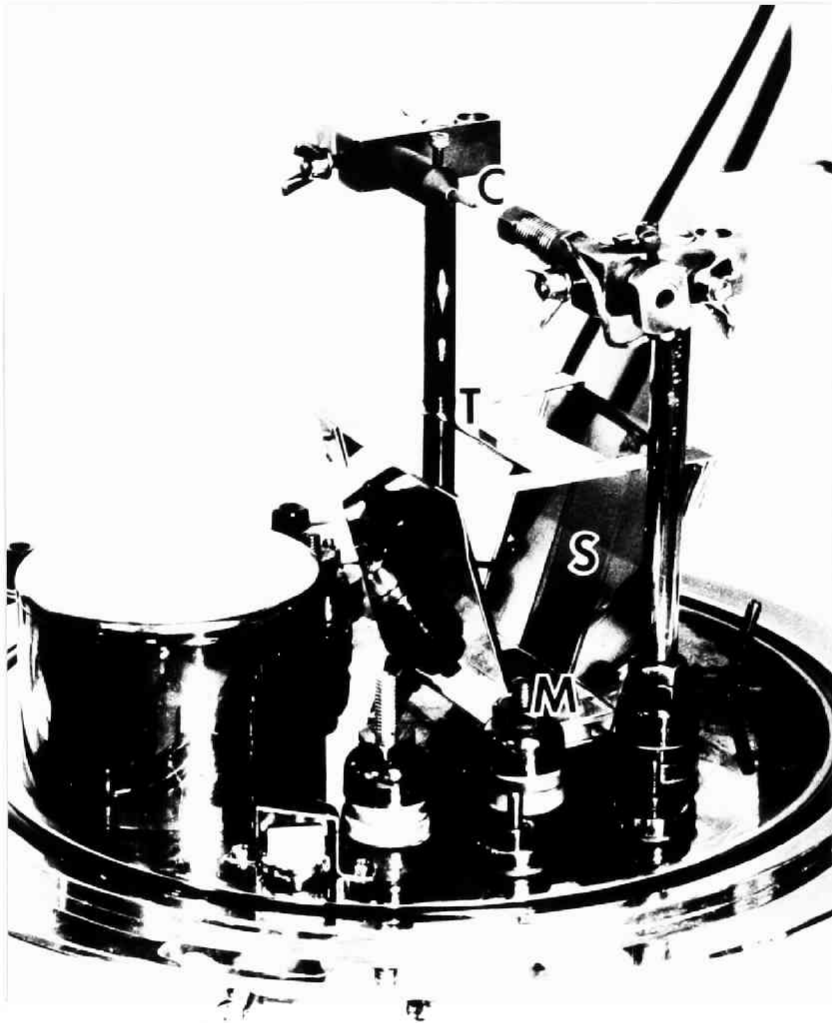
図10 間接蒸着の仕方。Cからカーボンを加熱蒸発させ、Tを直接マイカMに蒸着されるカーボンをさける。Sはスライドガラス
