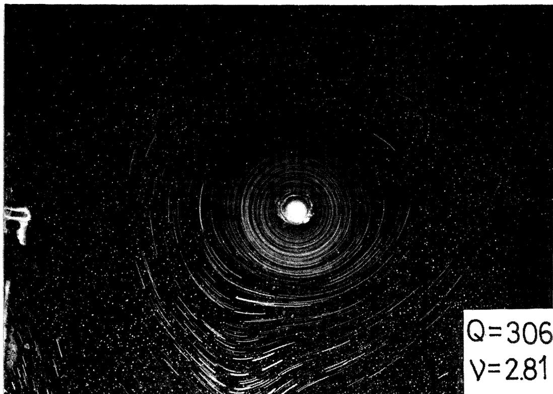
図1 矩形水槽中での吸い込み口のまわりの流線,  $Q$ は吸い込み口からの流出量 (cc/sec),  $\nu$ は動粘性係数 (cSt)。
