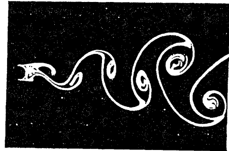
図4 円柱後方のカルマン渦列。 R = 140
