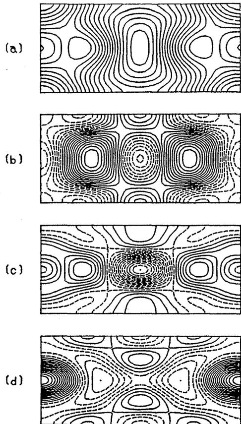
図2 温度場 $\theta(x, y, z = 0.25)$ の等値線。ただし $-\Gamma_X/2 < x < \Gamma_X/2, -\Gamma_Y/2 < y < \Gamma_Y/2, 1/2 < z < 1/2$ 。  $\Gamma_X = 1.2, \Gamma_Y = 2.7, \sigma = 0.5, s = R/R_0 = 4.529$ の場合で、実線は正、破線は負の値を示す。
