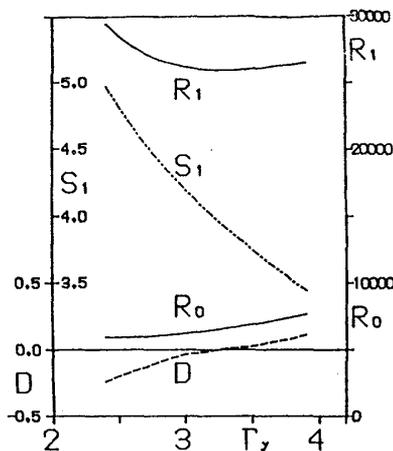
図1 中立安定曲線と線型成長率
