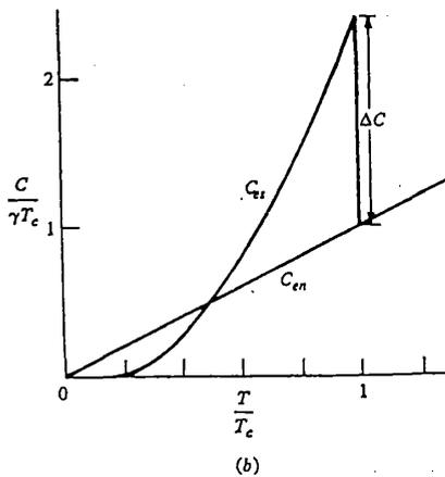
図7 BCS超伝導体の比熱の温度変化。
