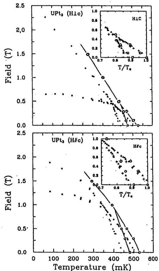
図13  $\text{UPt}_3$ の $H$ - $T$ 相図。■, ●, ▲: 音速測定
