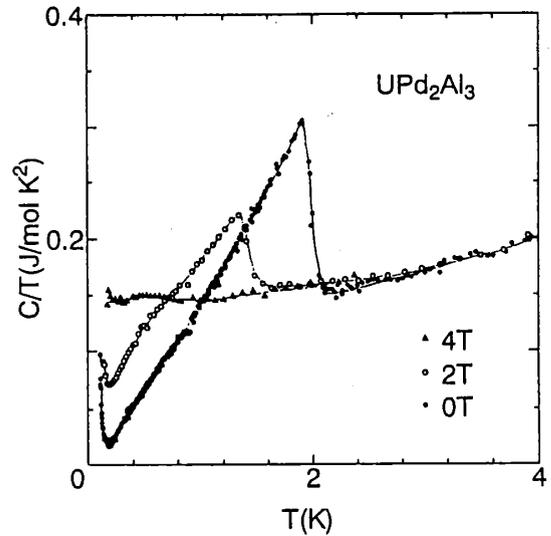
図9  $UPd_2Al_3$ の磁場中比熱の温度変化。
