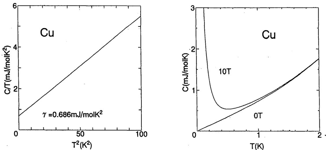
図1 (a) Cuのzero磁場での比熱。(b) Cuの磁場中比熱。低温強磁場中では核比熱が観測される。
