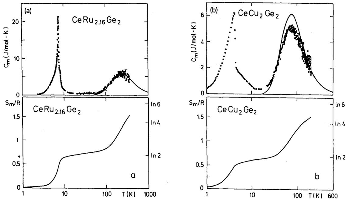
図3 (a)CeRu<sub>2.16</sub>Ge<sub>2</sub>と(b)CeCu<sub>2</sub>Ge<sub>2</sub>における4f-電子の比熱とentropyの温度変化。
