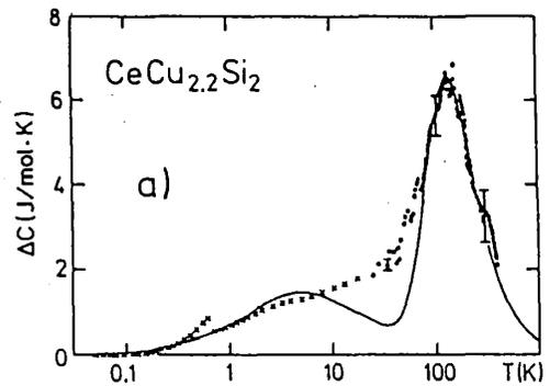
図4 CeCu<sub>2.2</sub>Si<sub>2</sub>における4f-電子の比熱
