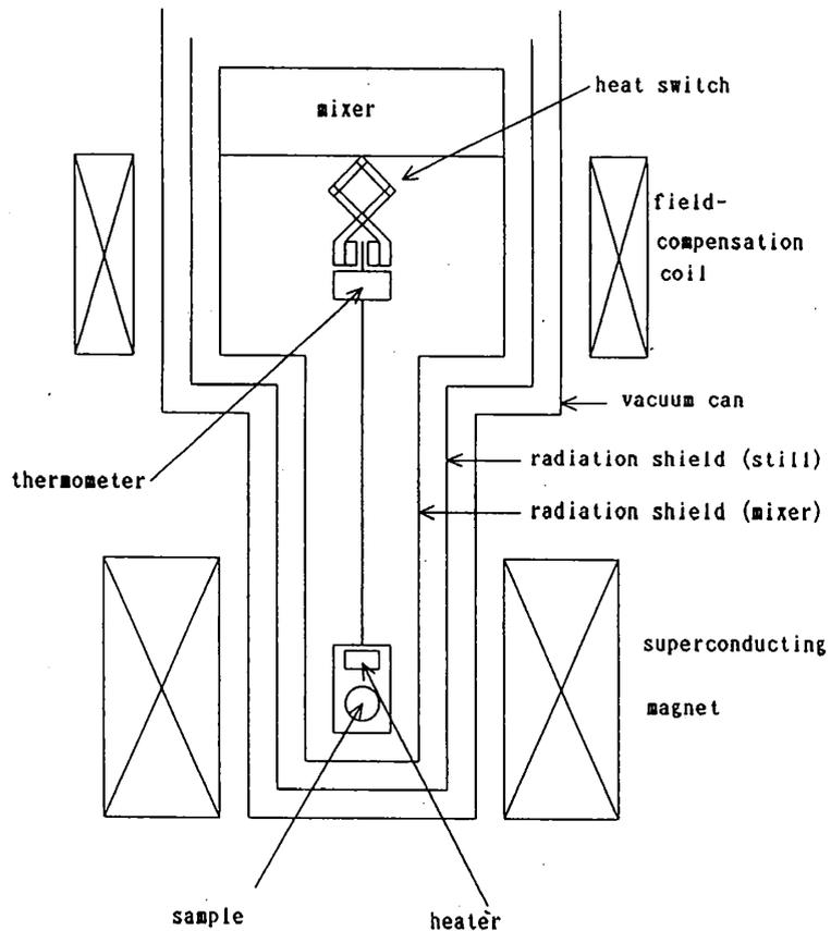
図14  $^3\text{He}/^4\text{He}$ 希釈冷凍機の比熱測定部。
