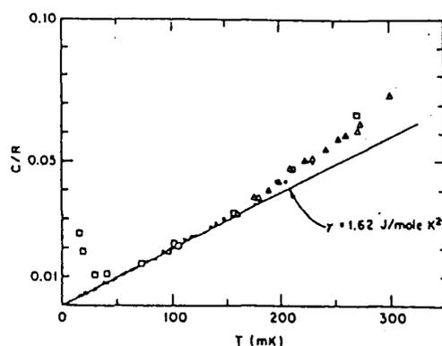
図2  $\text{CeAl}_3$ の低温比熱の温度変化。
