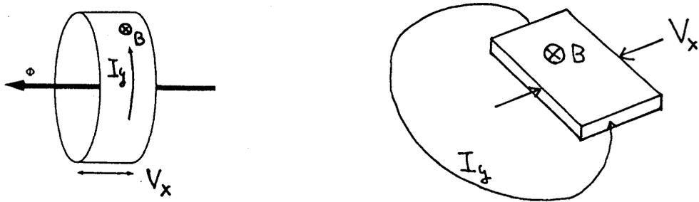
この配置で Laughlin は次のような議論をした。  $\Phi$  を断熱的に  $\Delta\Phi$  だけ変化させる。その過程で系にした仕事量が  $\Delta E$  であるとしよう。そのときシリンダーの輪方向の電流  $I_y$  はいわゆる Byers-Yang の公式<sup>11</sup> により、
