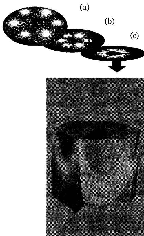
図 1-4 グラファイトのバンドの二次元測定例(a),(b),(c)と、それらを重ねて表示した3次元的な \pi バンド構造(d)
