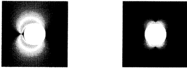
図 1: r_c/R_0 = 0.002 における平衡配向の構造. 無限遠での配向は z (横) 方向. 左は hedgehog 構造, 右は Saturn ring 構造. それぞれ Q_{zz}^2 のグレースケールプロット.
