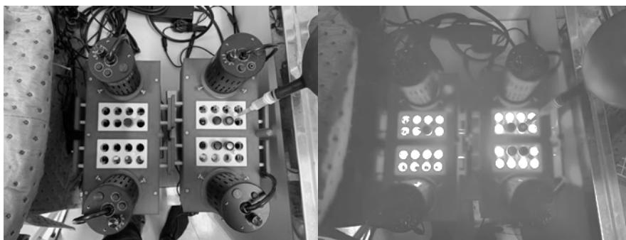
Figure 2-2. 条件 A^a , B^b 及び C^c の光反応セットアップ (EvoluChem photoreactor)
