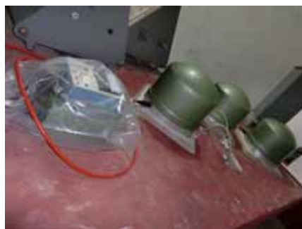
写真 3 STS 広帯域地震計 3 成分
