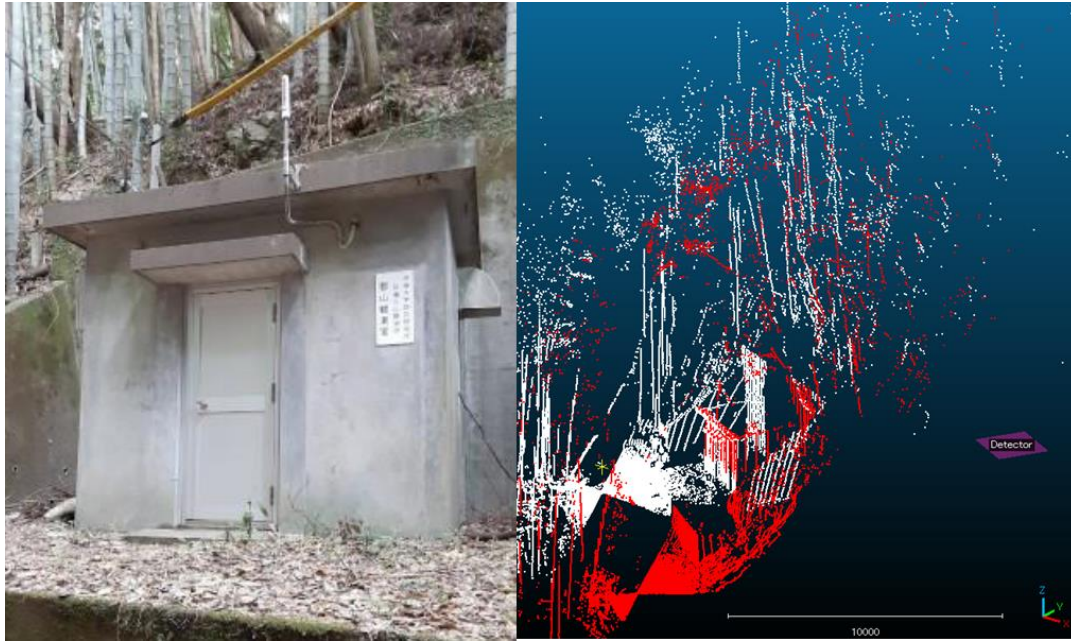
図 3：郡山観測室外観（左）と、小型 LiDAR 装置により撮影した周囲の点群地形（右）。
