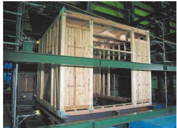
木造家屋試験体の設置状況
