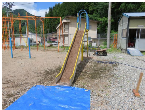
写真 1 滑り台での斜面崩壊・土石流実験
