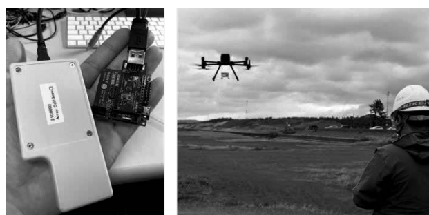
図 1 (左) 開発中の超小型 KURAMA-II。ボード上に GPS や LTE 通信機能も実装し、従来の KURAMA-II と同等の機能を有している。(右) ドローンに搭載されて総合防災訓練で活用される KURAMA-II。
