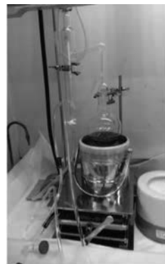
図 4-1 BDI およびその誘導体の調製に使用されるディーン・スタック装置
