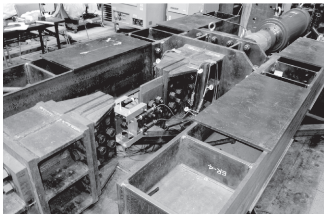
写真1 荷重装置に試験体を取り付けた状況
