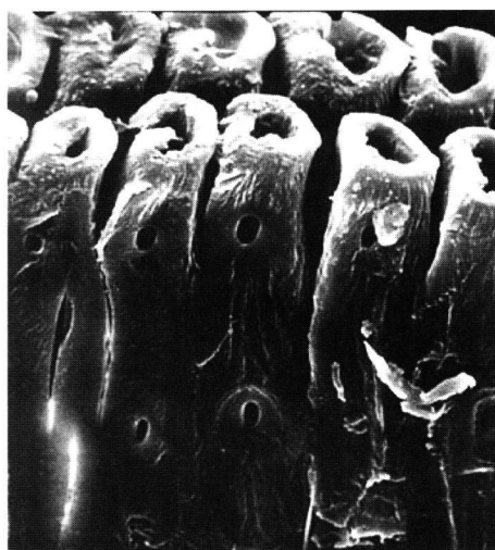
図 5：日射に曝された木材表面（細胞間層において顕著な成分分解が生じている。）
