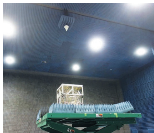
図2：長距離無線送電実証実験に用いた送電アンテナの実測試験写真
