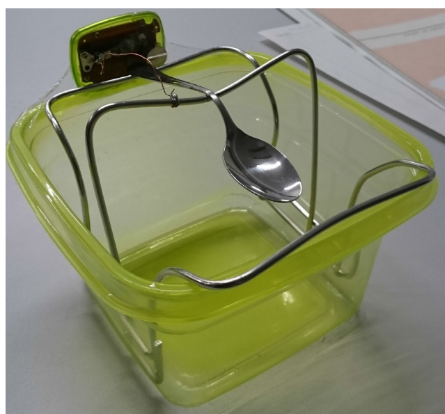
100円ショップで購入した4品を用いて専修コース受講生が作成した自動雨量計。
