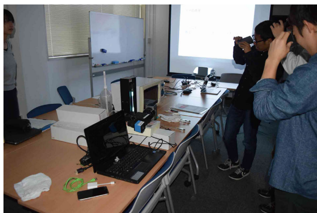
水銀のスペクトル管の発光を回折格子を用いた簡易分光計で観察する様子。スペクトル管の奥にはプラズマを発生させる電子レンジ、手前には、分光器と分光結果を表示させるノートPCがある。
